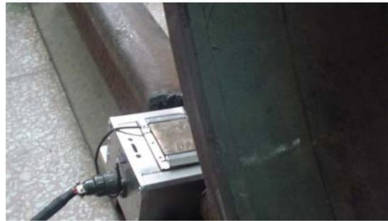
图 5 探头嵌入钢轨中的车轮踏面检测
